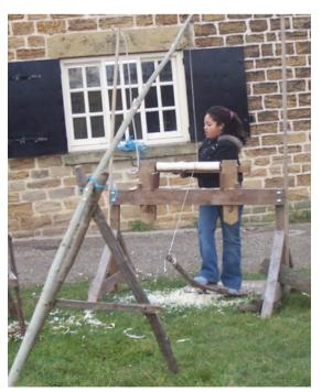
Using a pole lathe.
