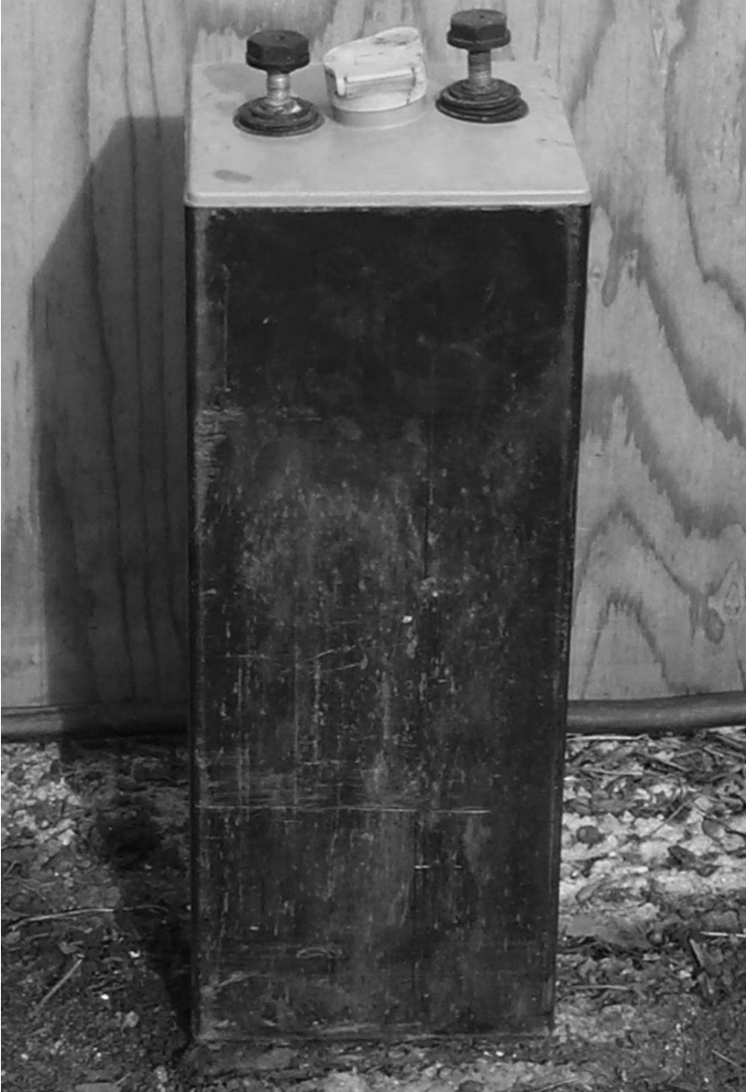
fig 33: 2 volt 500 amp hour forklift battery
